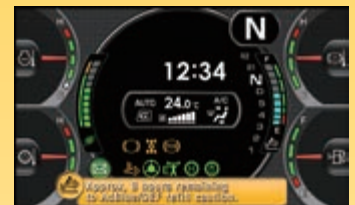
Assistance à la vérification du niveau et au remplissage du liquide AdBlue®
