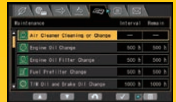
Écran de base de maintenance
