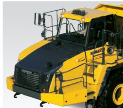
ROPS/FOPS intégrés conformes aux normes ISO 3471 et SAE J1040-1988c
