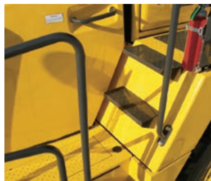
Accès sûr à la cabine à l'aide de main courante, loin des risques potentiels de l'articulation
