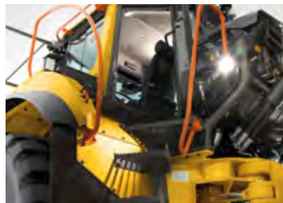
Eclairage de l'accès à la cabine
