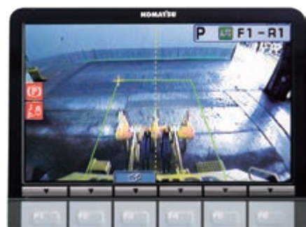
Système de caméra vue arrière complètement intégré
