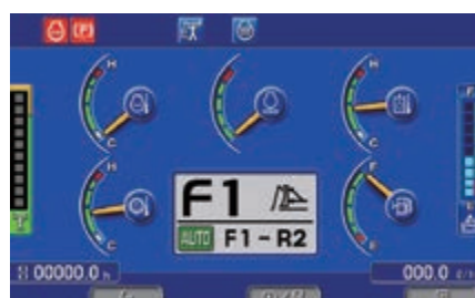
Le mode de changement de vitesse automatique aide à réduire davantage la consommation de carburant
