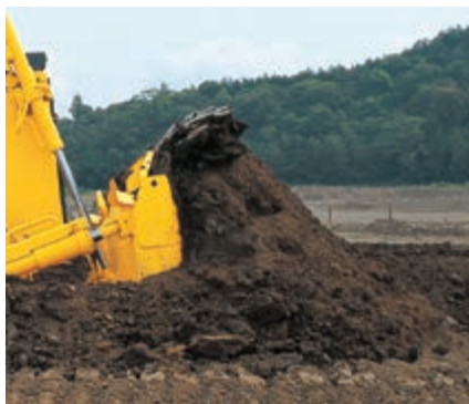
La lame Sigmadozer® offre une plus grande capacité de matériau à déplacer
