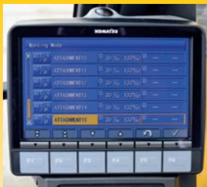
Le contrôle des équipements intégré Komatsu (KIAC) offre jusqu'à 15 présélections d'outils pour le débit et la pression d'huile (en option)
