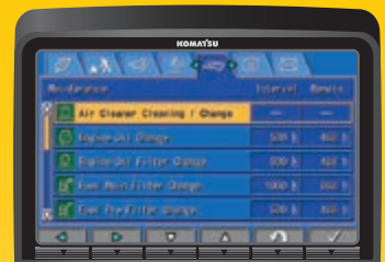
Écran de base de maintenance
