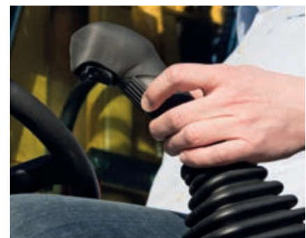
Pour les déplacements fréquents, le levier de direction réglable (en option) permet de contrôler la machine avec un effort moindre
