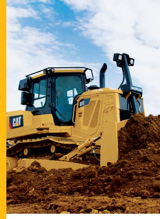
Le D7E Cat® a été conçu pour répondre à la demande croissante de tracteurs à chaînes à la fois puissants et très maniables. En adaptant la technologie de commande électrique aux besoins très spécifiques des applications de refoulement, Caterpillar a développé une toute nouvelle classe de tracteurs qui représentent le compromis idéal entre refoulement lourd et finissage soigné.
