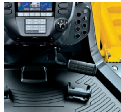
Le pilotage de la machine est facilité grâce à l'installation d'une seule pédale associant la commande de freinage et la pédale de décélération. La vitesse de déplacement est contrôlée à l'aide d'une seule pédale. La fonction de la pédale peut être modifiée à l'aide d'un sélecteur de mode.
